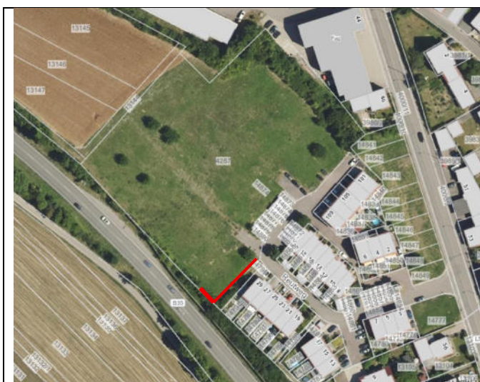
Abb. 8: Lage des Schutzzaunes zur Sicherung der vorhandenen Mauereidechsen mit einer Länge von ca. 35 m parallel zum Grundstück Reutweg 29 und Biegung. Die genaue Lage ist vor Ort mit den Bauplänen abzustimmen.
