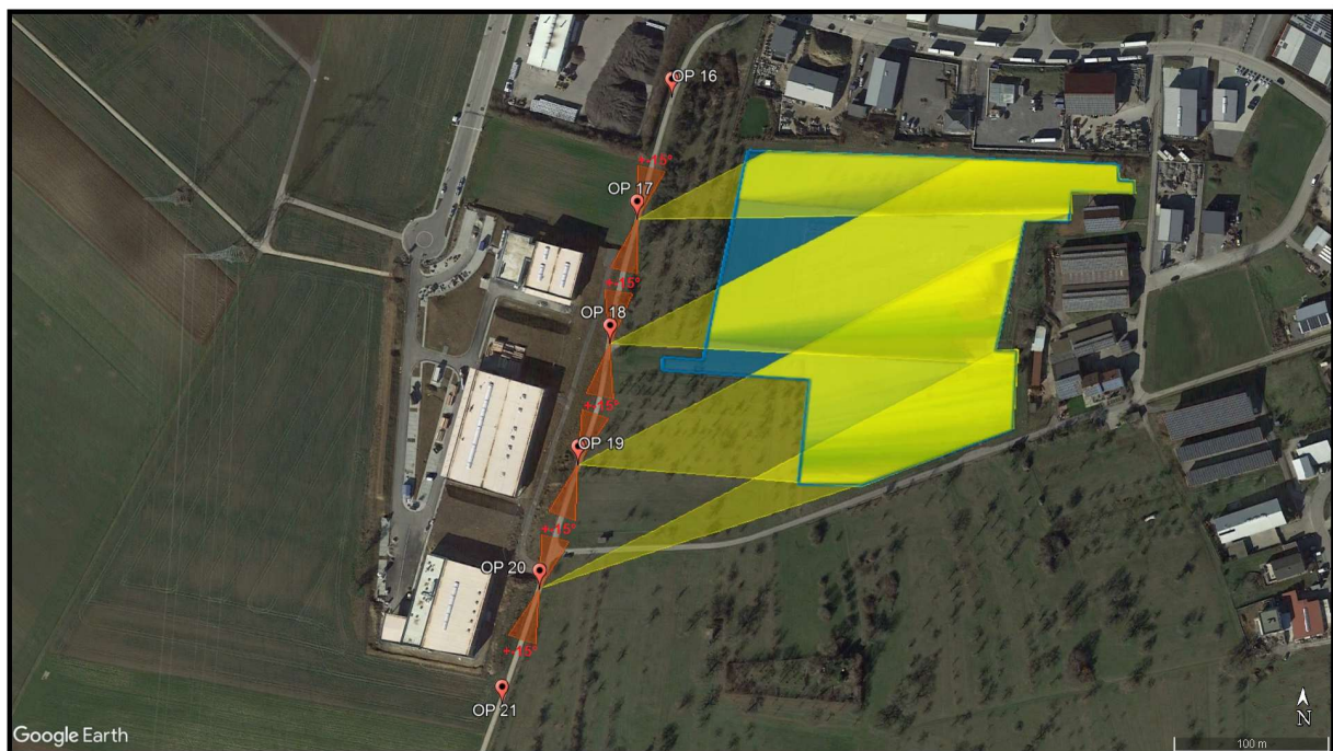
Abbildung 5: Blendungsmöglichkeiten eines Fahrradfahrers auf dem westlich der PVA angrenzenden Fahrradweg an den Immissionsorten OP 17-20 bei Vorbeifahrt in Nord- bzw. Südrichtung. Rote Bereiche: relevante Blickwinkel ( \pm 15^\circ ) des Fahrradfahrers. Gelbe Bereiche: immissionsortspezifische Blendwinkel des Modulfeldes.
